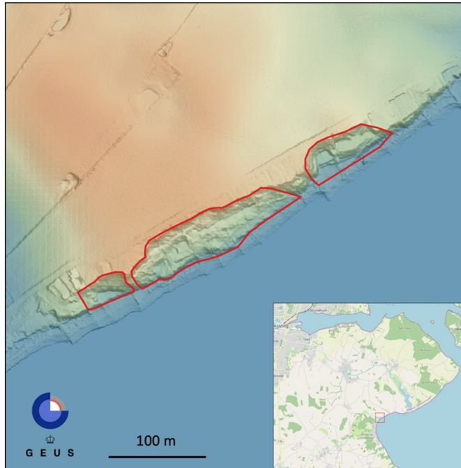
Figur 1. De kortlagte landskred ved Bjert Strand, Kolding Kommune. Figuren viser et udsnit af Danmarks højdemodel med skyggeeffekt, hvor de røde farver angiver det højeste terræn. De tre skred ses som områder med uregelmæssig overflade afgrænset med de røde linjer.
